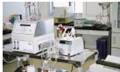
反芻家畜の基礎的な代謝生理を実験できる人工ルーメン装置
