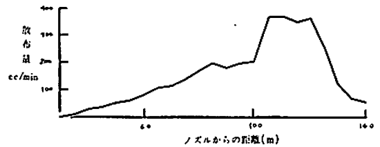
第63図 a M式4頭孔第1ノズル水平圧力25 kg/cm²
