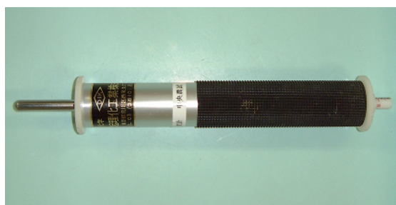
写真 2-1-1 本試験で使用したクラスト硬度計 (先端の球形スティック形状：φ 8mm × L54mm)
