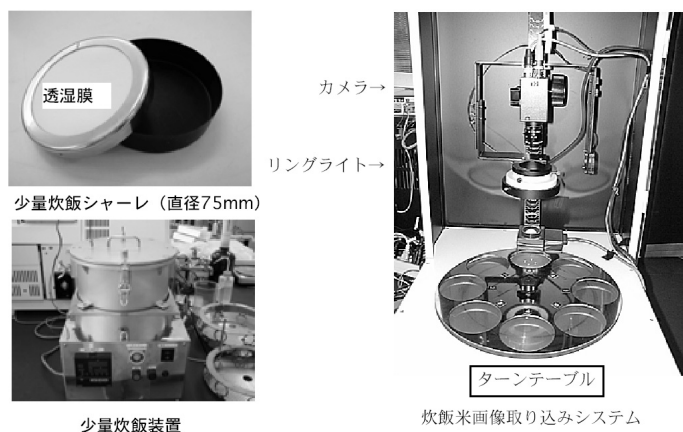
図Ⅲ-1-1 炊飯米外観測定システムの概要
