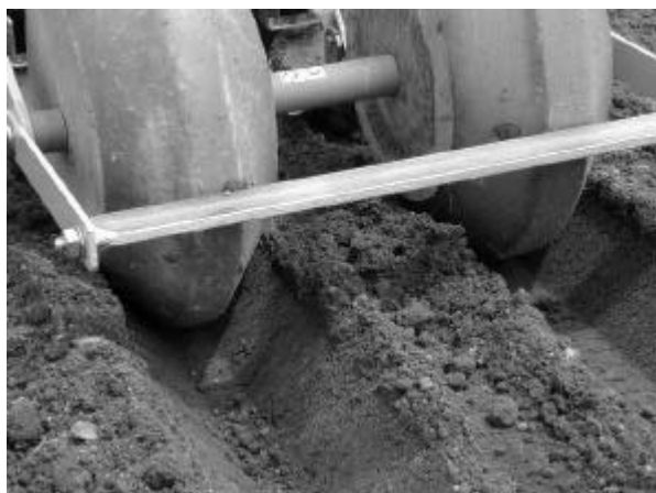
写真1 鎮圧輪と溝底播種後の畦
