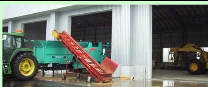
ラッパー体型細断型ロールベアを使った 試験では1時間で18個のロールを作りました。
