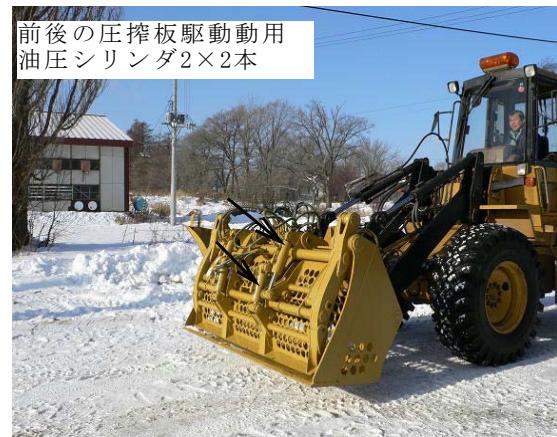
図1 ローダ装着型バケット（左：カバー開状態、右カバー閉状態）
