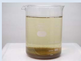
写真2 凝集沈殿処理直後
