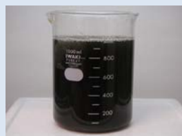
写真1 沈殿槽上澄み汚水
