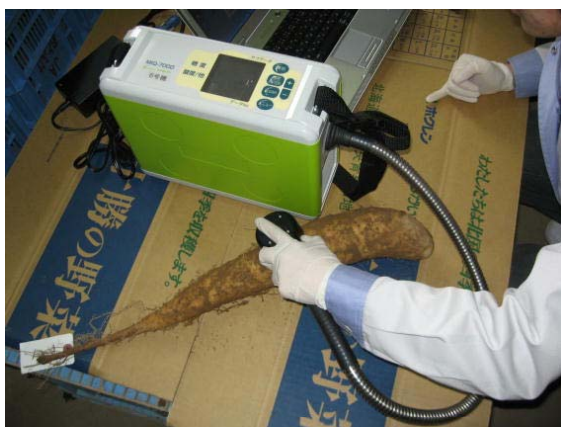
写真1 携帯型光センサーによる乾物率の測定
