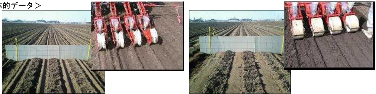
図1 鼓型鎮圧輪（左）と横行鎮圧輪（平滑円筒型）（右）
