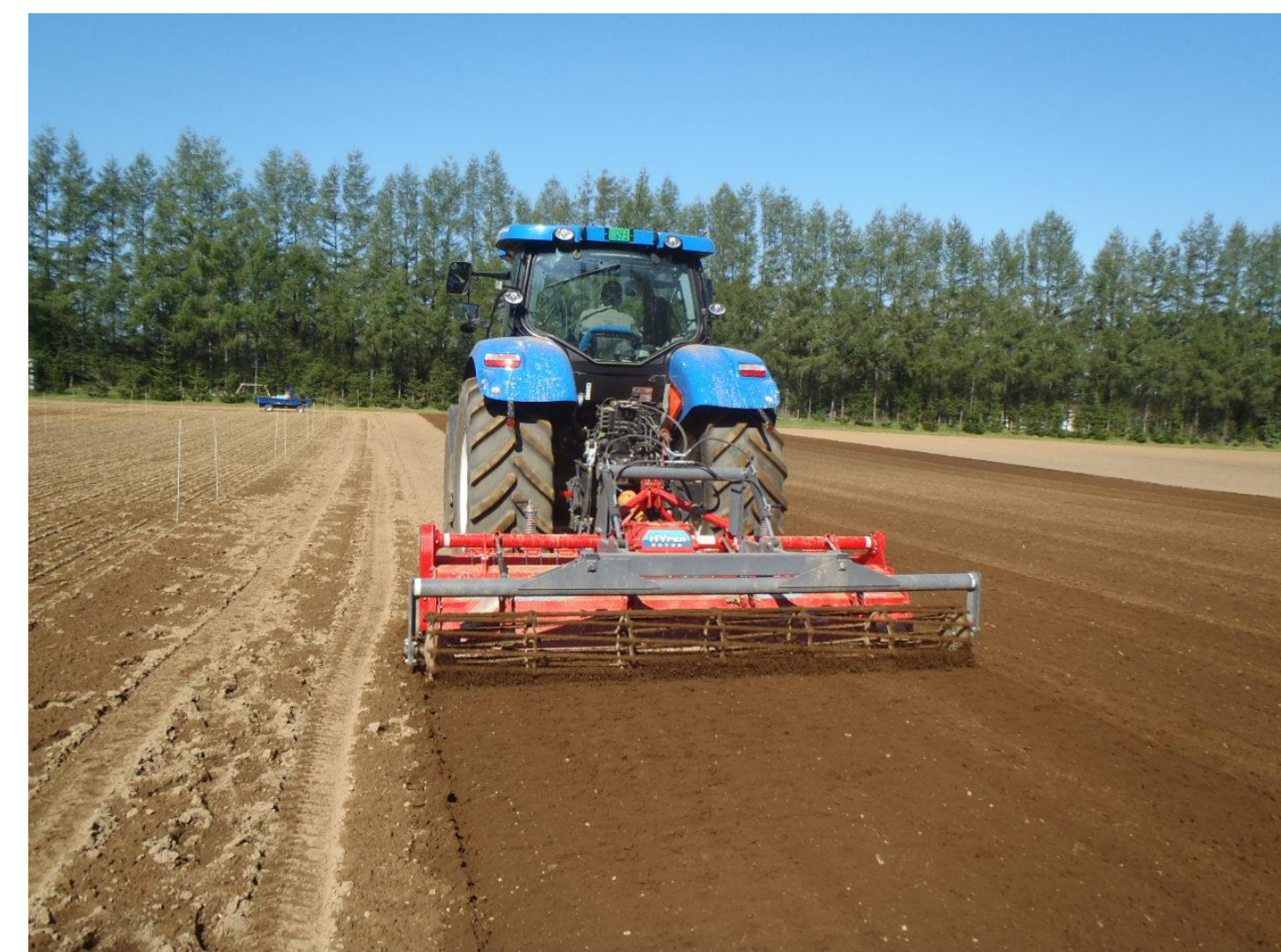
ロータリーハローによる 混和 （深さ約15cm）
