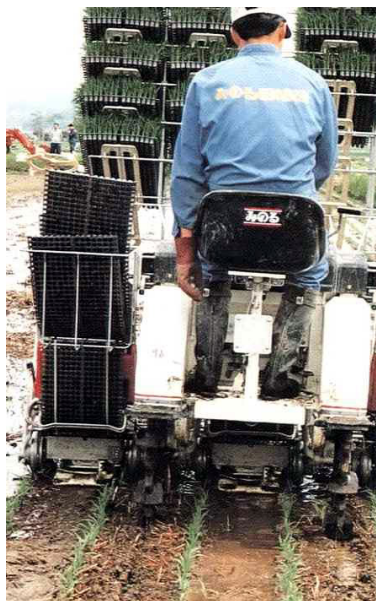
浅耕無代かき移植 (8cm程度の耕起で耕起・破土し 入水後に移植)
