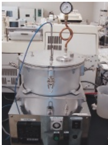
多点式少量炊飯装置 (一度に 24 点の少量炊飯可能)
