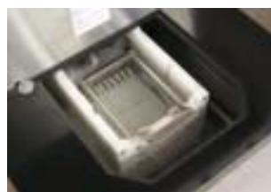
受精卵を封入したストローを凍結機にセットしたところ
