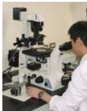
マイクロマニピュレータによる吸引操作
