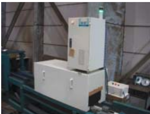
ばれいしょでん粉価測定・選別用光センサー本体
