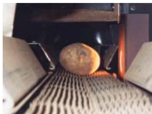
選果ライン上でのばれいしょのでん粉価測定 右側から光を当て、左側の検出器で透過光を受ける
