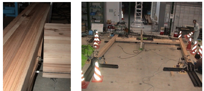
▲ 引きボルト式柱-梁接合架構の加力実験
