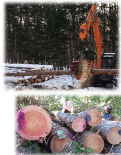
図1 ICTハーベスタによる造材作業と色分けされた丸太
