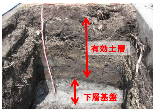
写真－4 街路樹の植栽基盤の状況
