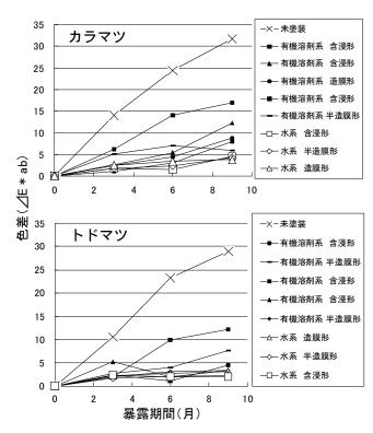
図1 屋外暴露試験による色差の変化
