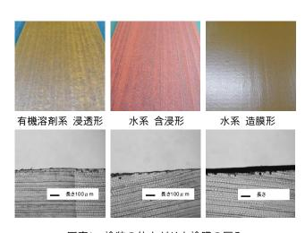
写真1 塗装の仕上がりと塗膜の厚み
