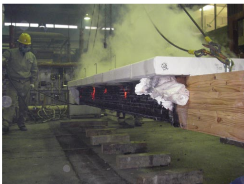
写真3 加熱終了直後の試験体の状態
