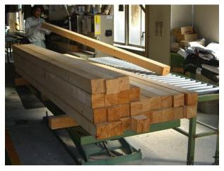
写真 材面を見ながらの荒削り作業
