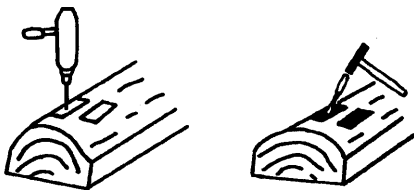
座板をホゾ穴加工
