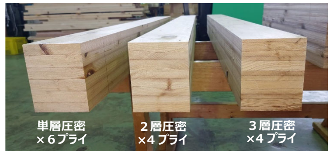
図5 圧密集成材の断面の様子
