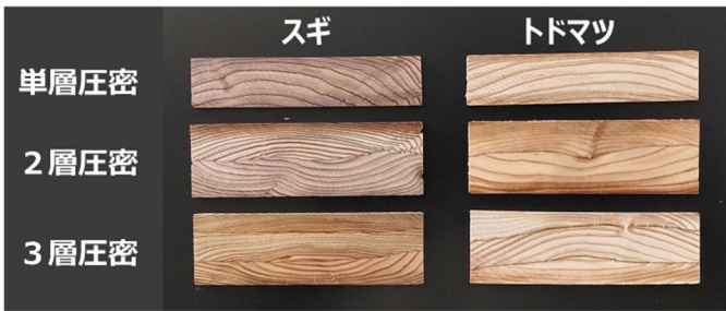
図2 圧密ラミナの断面
