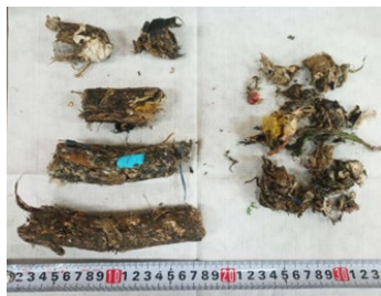
写真2 性状の不均質な燃料 長さが異なり、成形されていないものもあり、これを安定して燃焼できる設備の開発も実施した。
