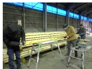
図7 製材の形状変化の測定
