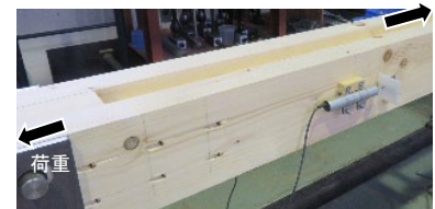
写真3 継手の引張試験
