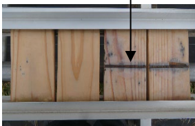
本研究の試み 傷を加えた試験体を用いる ことで劣化の促進を図る
