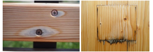
ビス周囲の塗膜のふくれ 加工部位のカビ汚染 図1 塗膜の美観低下の例
