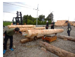
図4 トドマツ丸太のヤング係数測定
