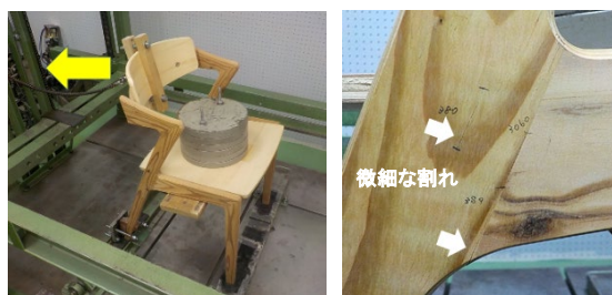
写真3 椅子フレームの繰り返し衝撃荷重試験
