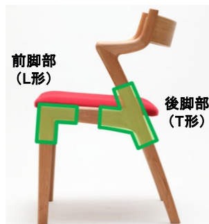
写真1 試験対象とした接合部位
