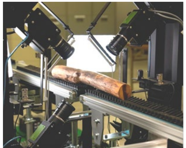
図 1 原木の外観から節を自動検出する装置（試験機） 写真提供：エノ産業株式会社
