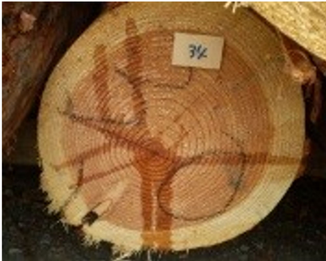
写真1 カラマツの心割れ
