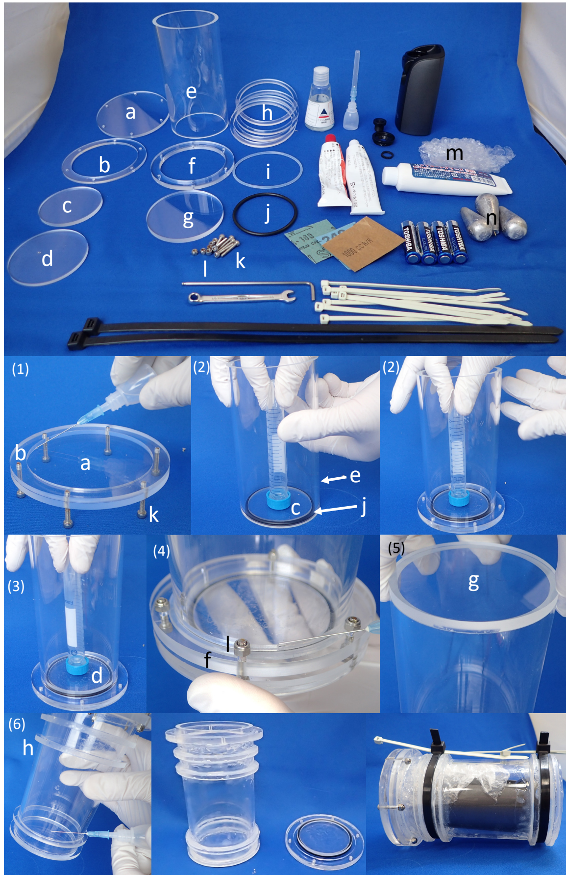
付録4 カメラハウジングの組立と本研究で用いたタイムラプスカメラ (TLC200Pro, Brinno) を使用するために必要な部品とカメラハウジング組立の各手順の作業写真。写真中の数字とアルファベットは、付録1と2と対応している。
