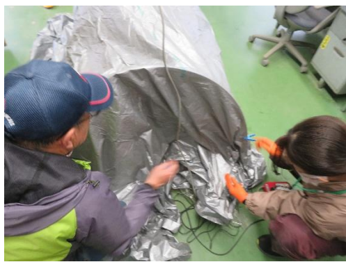
↑ オレンジの部分は電熱マットになっており、ビニールを掛けて保温します。
