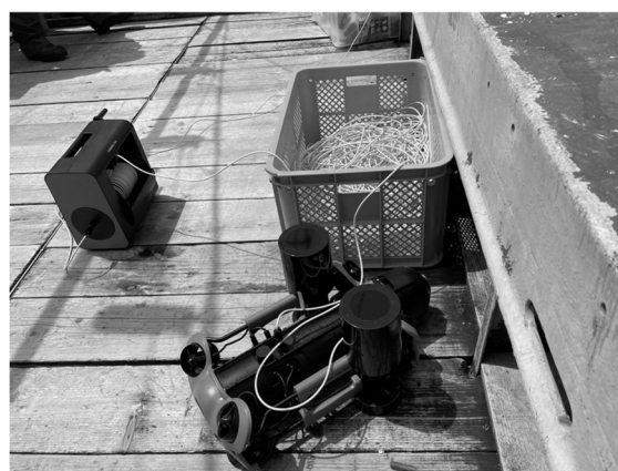
図 1 使用した水中ドローン
