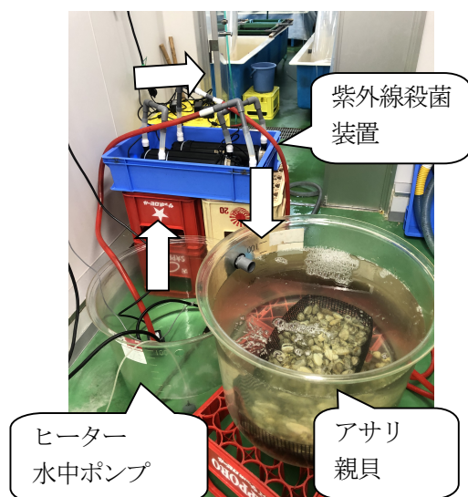
図4 試作した簡易産卵誘発装置 矢印は水の流れを示す。
