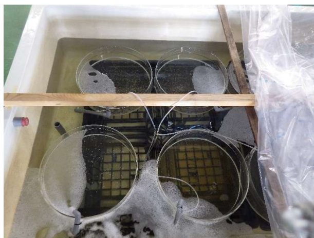
図 3 FRP 水槽中のダウンウェリング水槽 4 槽でアサリ稚貝育成
