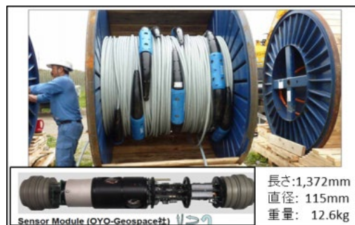
常設型OBC受振ケーブルの外観
