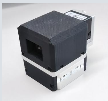
CMOSカメラと複数の光学フィルタで構成した多眼式分光イメージングセンサ
