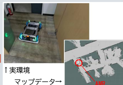
↑実環境 マップデータ→ 実環境における測域センサ（LiDAR） を使用した自律走行試験
