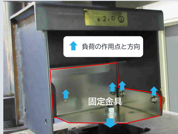
ボンベ収納庫固定金具の強度試験
