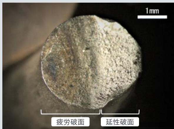
引張荷重を繰返して受ける ステンレス鋼製ばねの破面
