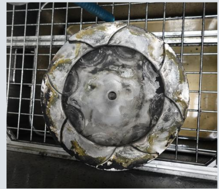
洗浄前後のピストンヘッドの外観写真 (左：洗浄前、右：洗浄後)
