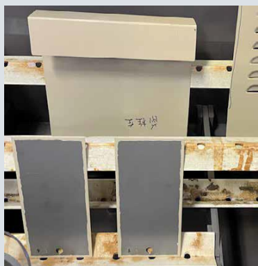
塗装鋼板の耐食性試験(右：腐食前、左：腐食後)
