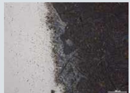
溶接部の断面組織
