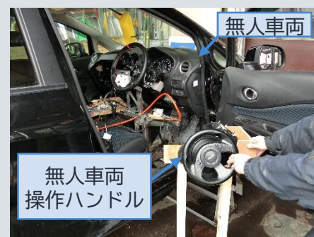
遠隔操縦システム (有人車両が後続し、手前の 操作ハンドルで制御)
