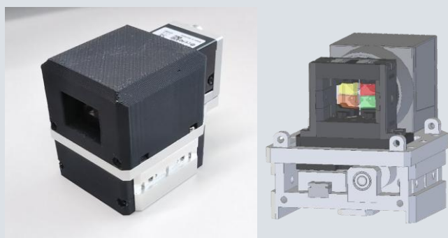
CMOSカメラと複数の光学フィルタで構成した 多眼式分光イメージングセンサ
