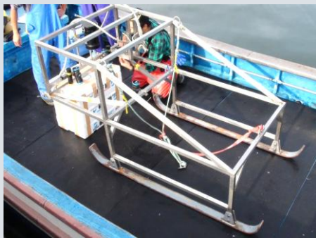
自動撮影カメラを搭載したけん引台車
