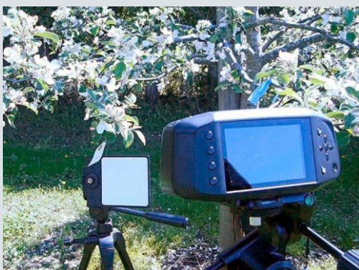
ハイパースペクトルカメラによる ほ場でのデータ収集
