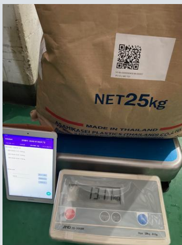
無線重量計とQRコード による材料の計量
