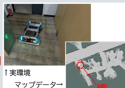
実環境における測域センサ（LiDAR）を使用した自律走行試験
