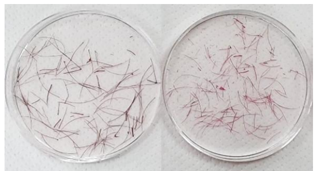
写真1 破碎試験後のニシン小骨の様子 左：酸浸漬なし 右：酸浸漬あり
