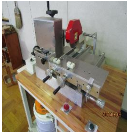
木片試験体加工用の小型昇降盤
