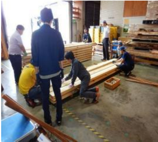
試験木材のヤング率測定
