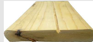
単純圧縮による変形と木目に沿った割れが発生
