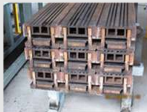
金属型枠を使用した圧縮木材製造の問題点 →型枠費用が高価 (特に右側の例) →圧縮後の板材寸法が限定される
