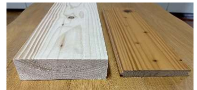
左: 圧縮前のトドマツ板材 (爪で簡単に傷がつく) 右: 約半分の厚さまで圧縮したもの (簡単に傷がつかない)
