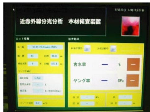
写真1 近赤外線で木の性質を測定しているところ（上）と測定結果を表示するパネル（下） （林産試だより2011年6月号より）
