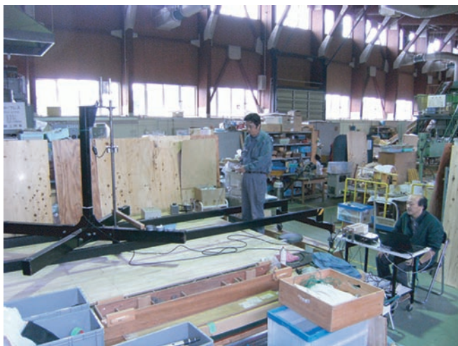
JIS A6519「体育館用鋼製床下地構成材」に規定される「床の弾力性試験」を実施中（平成23年9月，粉碎成形試験室）
