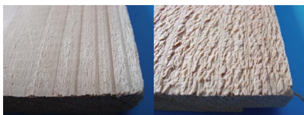
図1 素地仕上げの一例 左：プレーナー仕上げ 右：粗挽き仕上げ
