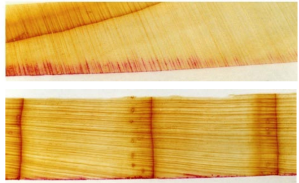
写真5 カラマツ 35℃乾燥心材の半径方向、接線方向の浸透 上が半径方向、下が接線方向
