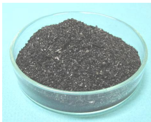
写真2 セシウム・ストロンチウム吸着材
