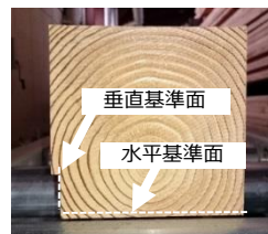
図3 修正挽き装置での加工後の断面
