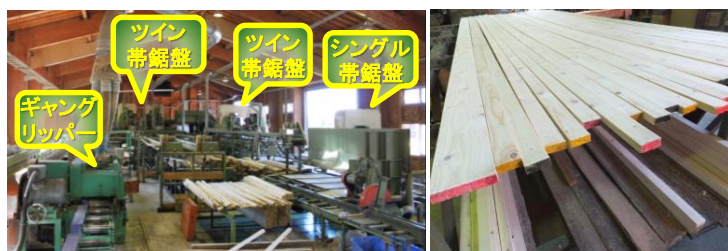
写真 製材時における割れの調査
