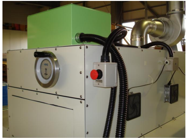
写真2 ランプハウス中央部 (上下ハンドル・緊急停止SW・吸排気ファン)
