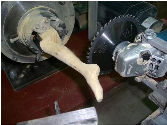
写真1 チップソーを用いたCNC木工旋盤
