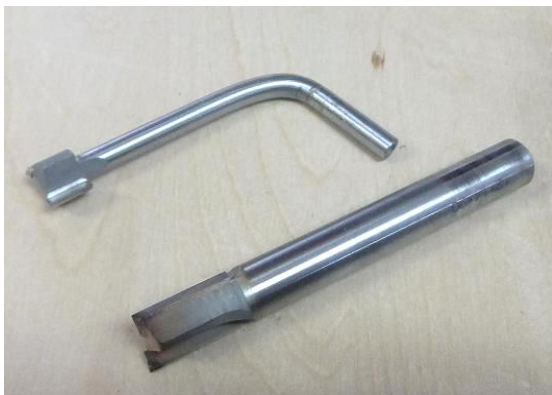
写真3 上：折れ曲がったシャンク（φ6） 下：今回用いたシャンク（φ12）
